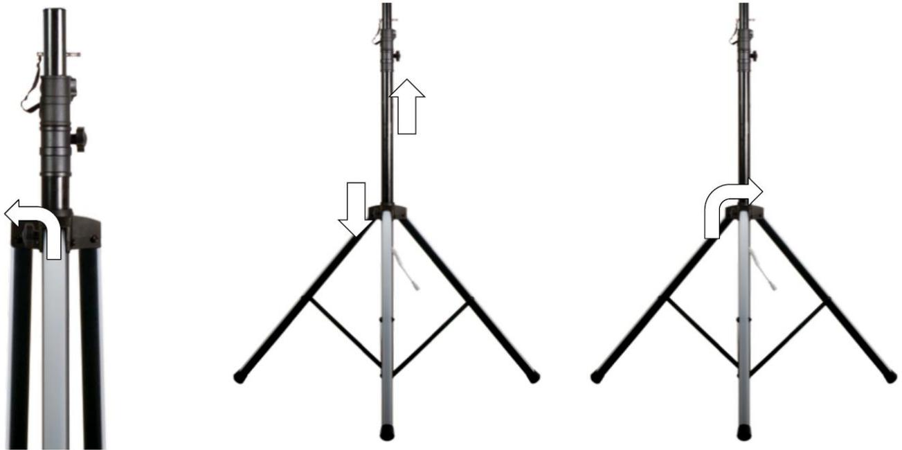
Afloje el mando A girándolo en sentido antihorario. Alargue el tubo interno hasta la altura deseada e inserte el pasador de seguridad por los agujeros de tope del tubo interno. Fije y apriete el mando A girándolo en sentido horario.
