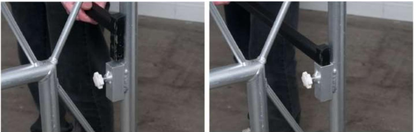
5. Serrez à la main les 4 vis à ailerons sur les fentes de chaque côté de la table.
