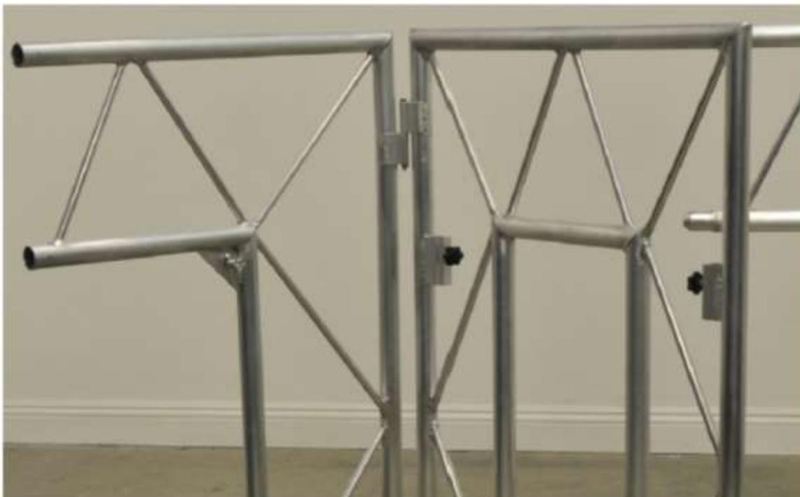
2. Alignez les deux moitiés de la table et insérez le tube de connexion d'un côté dans l'autre
