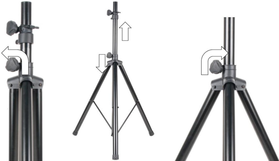
Allentare la manopola A ruotandola in senso antiorario. Estendere il tubo interno fino all'altezza desiderata e inserire il perno di sicurezza attraverso i fori di blocco del tubo interno. Serrare la manopola A ruotandola in senso orario.
