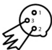
Der Endwiderstand reduziert Datenfehler und verhindert Probleme bei der Datenübertragung und im Datenempfang. Es ist immer Empfehlenswert einen DMX Terminal (Widerstand 120 Ohm 1/4 W) zwischen PIN2 (DMX-) und PIN 3 (DMX+) vom letzten Stecker zu verbinden.
