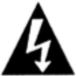
Ce symbole est utilisé pour indiquer à l'utilisateur la présence à l'intérieur de ce produit de tension non-isolée dangereuse pouvant être d'intensité suffisante pour constituer un risque de choc électrique important.
