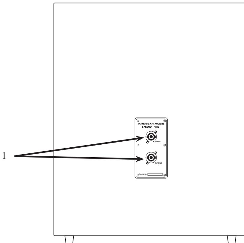
**1. CONEXIONES SPEAKON** – El PSW 15 incluye dos conexiones Speakon. Usted puede utilizar ambas conexiones juntas para enlazar los subwoofers. Los conectores Speakon cuentan con una configuración del pasador 1+ (con corriente) y 1- (a tierra); los pasadores 2+ y 2- no se utilizan. Si desea más información sobre cableado de conectores Speakon, remítase a la página 17.
