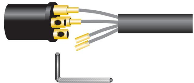
4. Asegúrese de que coincidan correctamente los extremos positivo (+) y negativo (-) de cada cable (Figura 13).
