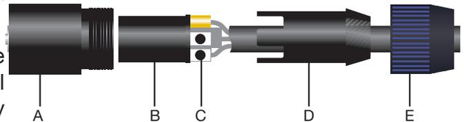
3. Coloque cada cable con los casquillos de bronce en la parte superior de la ranura correspondiente del conector (B), según se muestra en las figuras 11 y 12. Utilice una llave Allen de 1,5-mm para ajustar la conexión (Figura 12).
