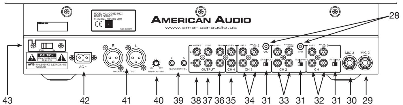
**28. GND (TERMINAL A TIERRA)** – Asegúrese de conectar cables a tierra para bandeja giradiscos a una o a las dos terminales a tierra disponibles. Esto reducirá los zumbidos y estallidos asociados con los cartuchos phono magnéticos.
