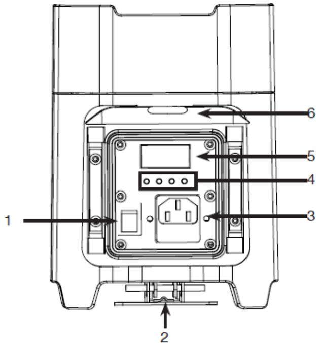
1. Interruttore On/Off della batteria: utilizzato per attivare l'alimentazione batteria. È inoltre necessario attivare la funzione LOAD (carico) (vedere a pagina 17 "Impostazioni Load").
