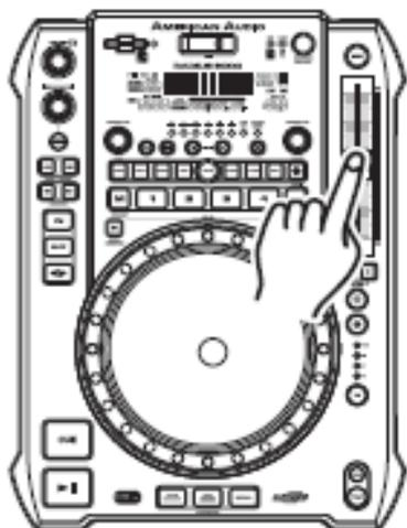
**Utiliser le Pitch Slider (4) :** Assurez-vous que la fonction pitch a été activée comme décrit ci-dessus. Pour utiliser le *PITCH SLIDER (4)*, faites glisser le curseur de haut en bas. Le descendre augmente le pitch et le monter permet de réduire le pitch.
