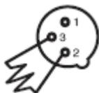
Le bouchon réduit les erreurs de signal et évite les problèmes de transmission de signal et les interférences. Il est toujours recommandé de connecter un bouchon DMX (résistance 120 Ohm 1/4 W) entre la broche 2 (DMX-) et la broche 3 (DMX +) de la dernière unité
