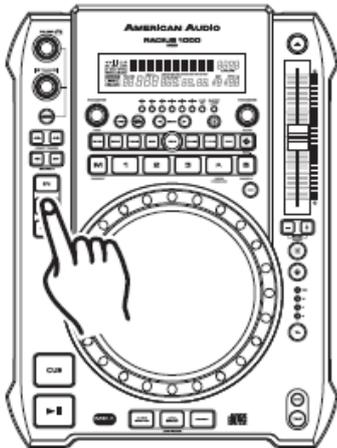
3) Premere il pulsante *OUT* (15) per impostare il punto di arrivo del CICLO CONTINUO (Figura 20). I LED dei pulsanti *IN* (15) e *OUT* (15) inizieranno subito a lampeggiare velocemente indicando che è stata attivata la modalità CICLO CONTINUO.
