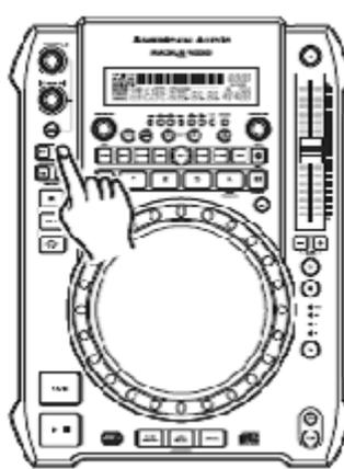
Battendo leggermente il pulsante track avanti oppure ruotando in senso orario la manopola track si salta alla traccia seguente.
