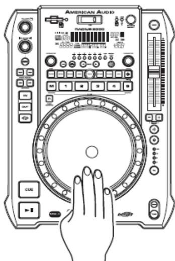
**In Modalità Cue:** in modalità cue e con la funzione sensibilità al tocco attivata si può battere leggermente sulla *Jog Wheel* (9) per avviare la riproduzione. L'apparecchiatura continuerà a riprodurre fin quando la *Jog Wheel* (9) viene rilasciata. Dopo aver rilasciato la *Jog Wheel* (9) l'apparecchiatura si riporterà all'ultimo "cue point" impostato.
