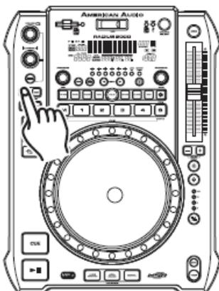
Battendo leggermente il pulsante track reverse oppure ruotando in senso antiorario la manopola track si salta alla traccia precedente.
