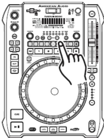
**EFFETTO PHASE:** L'effetto Phase modifica leggermente il suono originale per aggiungere una diversa definizione tonale. L'Effetto Phase ha due parametri modificabili, il Parametro Tempo (PT) e il Parametro Ratio (PR). Il PT modifica l'Intervallo di Tempo; il PR modifica l'Intervallo di Frequenza (vedere "Parametri" nella sezione successiva).
