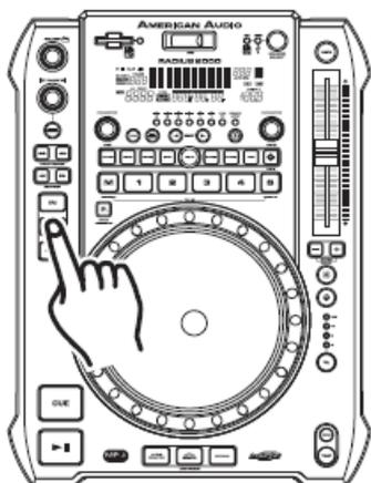
3) Premere il pulsante *OUT* (15) per impostare il punto di arrivo del CICLO CONTINUO (Figura 18). I LED dei pulsanti *IN* (15) e *OUT* (15) inizieranno subito a lampeggiare velocemente indicando che è stata attivata la modalità CICLO CONTINUO.
