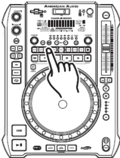
**EFFETTO TRANS** : l'effetto Trans simula l'effetto di trasformazione incrociata di un vero mixer. L'effetto Trans ha due parametri modificabili, il Parametro Tempo (PT) e il Parametro Ratio (PR). Il PT modifica la Velocità di Trasformazione; il PR modifica la Lunghezza Audio di Trasformazione.
