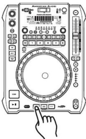
**ATTIVARE LA SENSIBILITA' AL TOCCO:** Attivare la sensibilità al tocco della *Jog Wheel* (9) prima di utilizzarla per controllare i comandi di riproduzione e di cue. Per attivare la modalità di sensibilità al tocco premere il pulsante *AUTO CUE SCRATCH* (12). Si attiverà la modalità di sensibilità al tocco.
