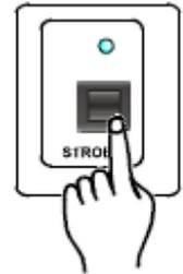
(2) Sie können die Blitzrate des Stroboskops jederzeit anpassen, indem Sie die „Strobe“-Taste gedrückt halten und den Speed-Überblendregler manuell anpassen.
