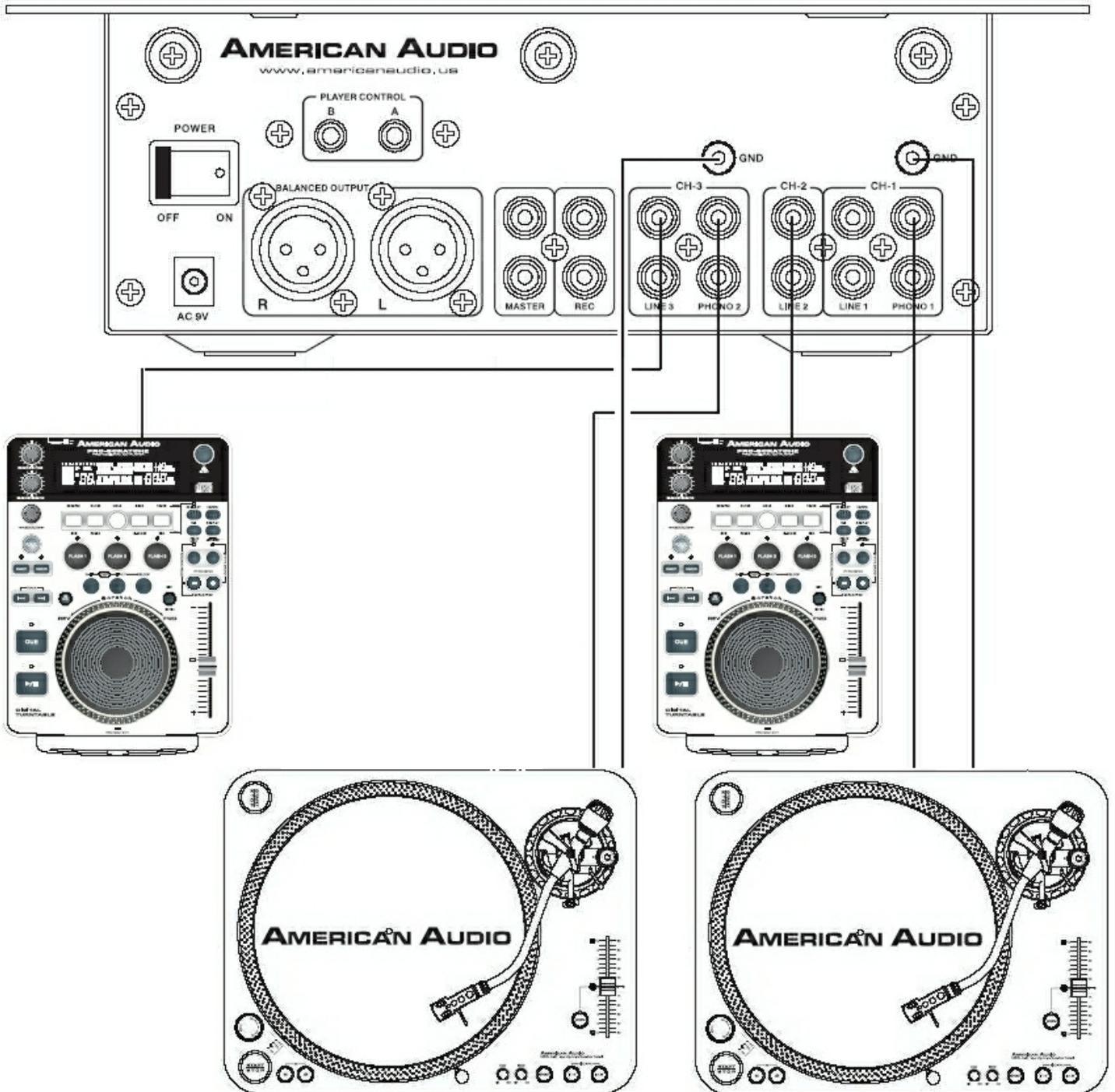
Diese Abbildung zeigt einen typischen Aufbau eines DJ Sets, bestehend aus:, zwei Plattenspielern, zwei CD Playern
