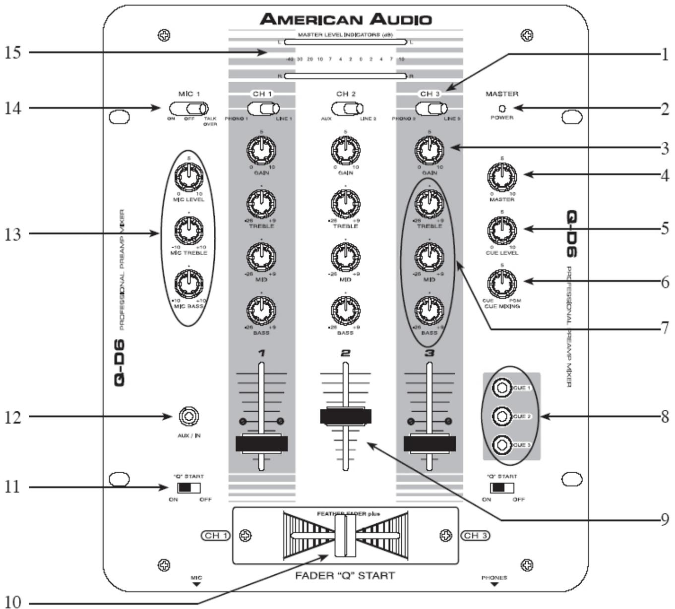
1. **PHONO/AUX/LINE** Schalter - Eingangsumschalter für jeden einzelnen Kanal. Kanal 1 und 2 können auf PHONO/AUX oder LINE, Kanal 3 auf LINE 3 oder LINE 4 gesetzt werden. Die Wahlschalter für AUX1/PHONO1 und AUX2/PHONO2 befinden sich auf der Geräterückseite.
