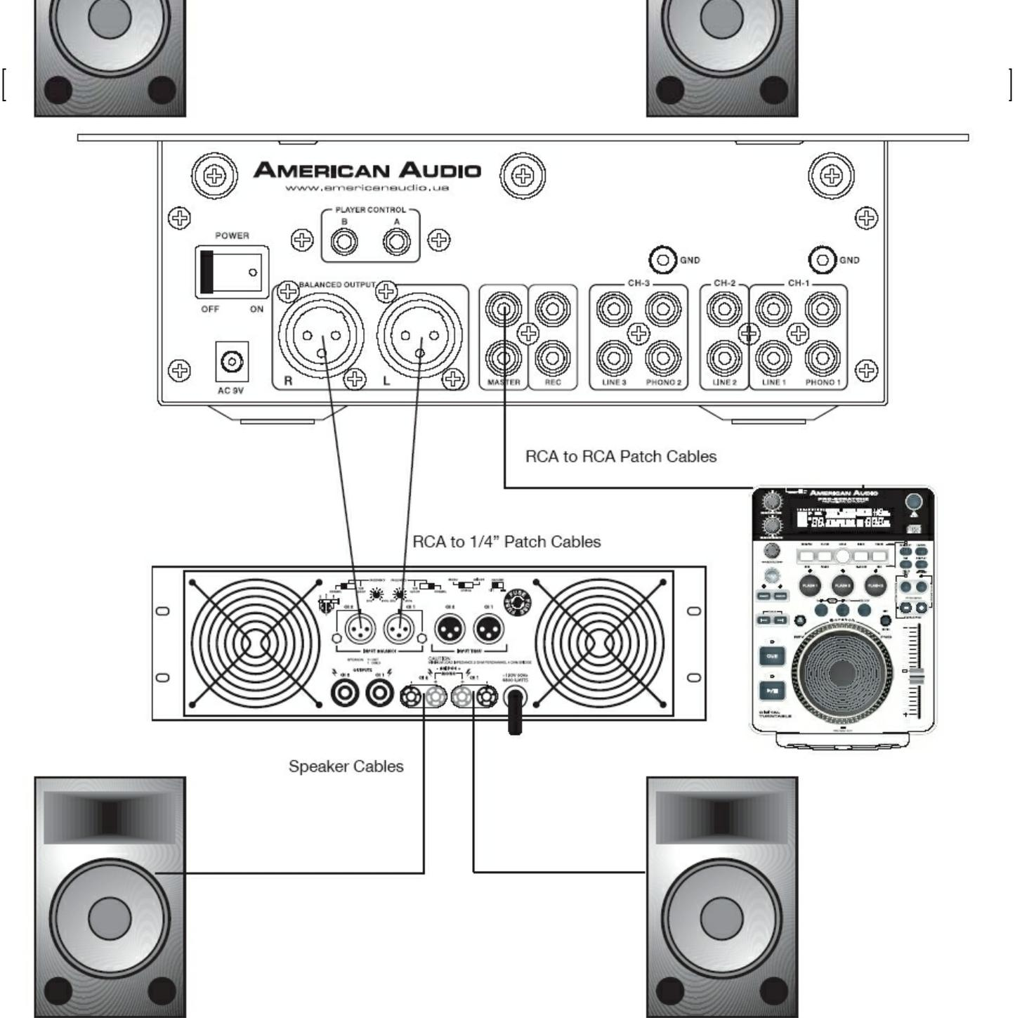
Typischer Aufbau mit Anschluss an ein Lautsprechersystem über die balanced XLR Ausgänge. Verwenden Sie diese Ausgänge wenn möglich immer. Verwenden Sie diesen Ausgang immer bei Kabellängen, grösser als 5 Meter. Dadurch wird ein sauberes, klares Signal gewährleistet.
