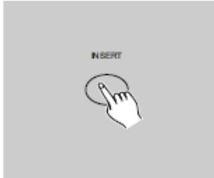
4. Drücken Sie auf die Insert-Taste, um den zuvor erstellten Schritt einzufügen; alle LEDs blinken und zeigen damit an, dass der Schritt eingefügt wurde.
