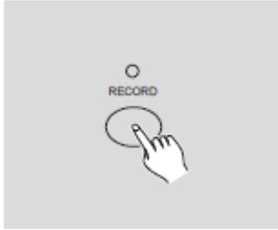
1. Vergewissern Sie sich, dass sich das Gerät im Record-Modus befindet.
