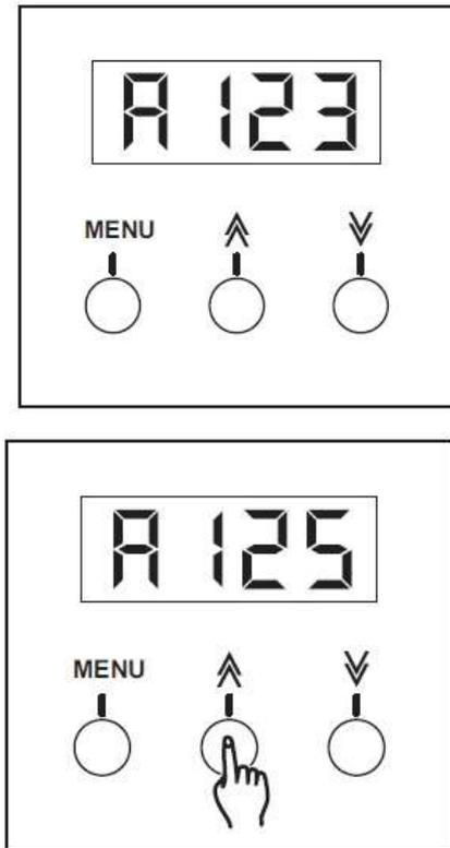
1. Premere il pulsante "MENU" fino a visualizzare la lettera "A" sul lato sinistro del display. Sul display viene visualizzata la "A" seguita dall'impostazione di indirizzo corrente. Per esempio, se l'ultimo canale DMX impostato era 123, sul display apparirà l'immagine riportata a sinistra.
