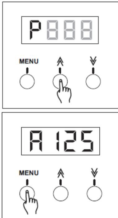
6. Battere leggermente sul pulsante ▲ oppure ▼ per accedere ad un valore di attenuazione preimpostato compreso tra 00 e 100. Ogni battuta aumenterà o diminuirà il valore una volta. Tenendo premuto il pulsante ▲ oppure ▼ il valore cambierà velocemente.
