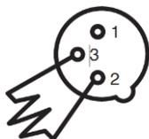
Le bouchon de terminaison réduit les erreurs de signal et évite les problèmes de transmission de signal et les interférences. Il est toujours recommandé de connecter un bouchon DMX (résistance 120 Ohm ¼ W) entre la broche 2 (DMX-) et la broche 3 (DMX+) de la dernière unité.
