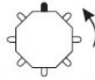
Für die Rotation zweier gegenüberliegender Balken im Uhrzeigersinn, schalten Sie den DIP-Schalter 8 auf die On Position und die DIP-Schalter 9 & 10 in die Off Position.
