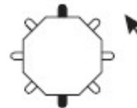
Für die Rotation von vier gegenüberliegenden Balken im Uhrzeigersinn, schalten Sie den DIP-Schalter 9 auf die On Position und die DIP-Schalter 8 & 10 in die Off Position.
