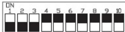
Für die Rotation eines einzelnen Balkens gegen den Uhrzeigersinn, schalten Sie die DIP-Schalter 8 & 10 auf die On Position und den DIP-Schalter 9 in die Off Position.
