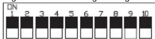
Die DIP-Schalter 8 – 10 ermöglichen es Ihnen ein Programm und die Rotationsrichtung einzustellen.
