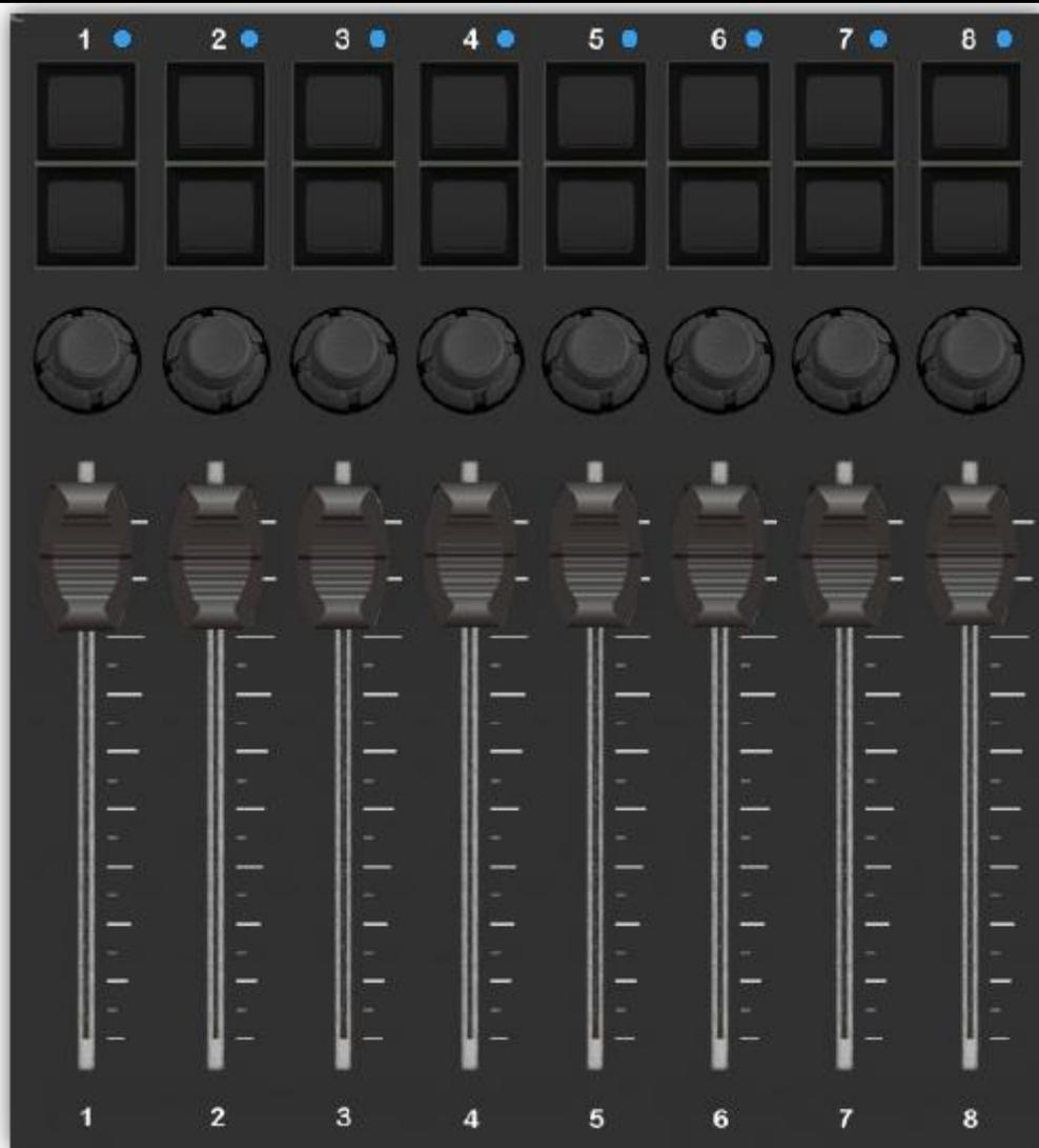
La sezione Riproduzione (Playback) è progettata per sfruttare le funzionalità di riproduzione della maggior parte dei software di illuminazione in cui si utilizzano cursori di riproduzione ed alcuni pulsanti associati. Sopra ogni cursore sono presenti due pulsanti: un piccolo encoder rotante ed un LED bicolore. Le funzioni di ciascuno variano in funzione del software utilizzato.
