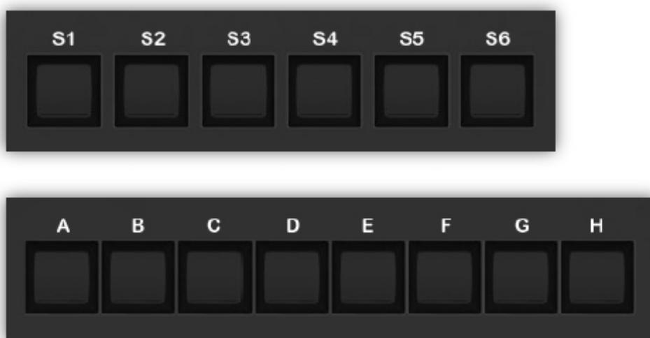
Questi 14 pulsanti sono destinati alle funzioni del software utilizzate frequentemente. Se il controller non supporta **MIDICON-2™** come plug-and-play, sarà necessario collegare ciascun pulsante ad una funzione utilizzando il menù di impostazione del software. Dato che sono diverse per ciascun programma, per le relative istruzioni fare riferimento alle istruzioni software. Per i messaggi nota MIDI predefiniti di ciascun pulsante fare riferimento alla tabella MIDI alla fine del manuale.
