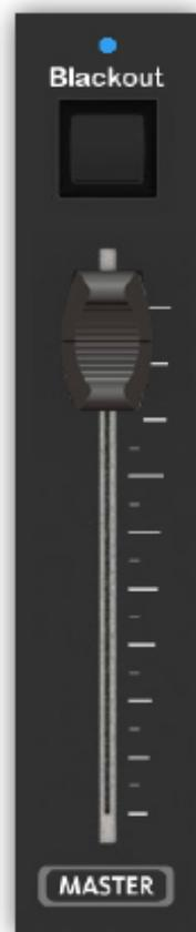
Il cursore Master viene generalmente utilizzato per controllare il livello globale delle luci di scena, ma è anche possibile utilizzarlo per altri controlli, quali la velocità, oppure come altro cursore di riproduzione. Questo cursore non è collegato ai controlli di pagina.
