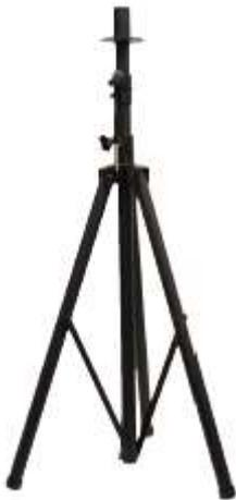
**Supporti SPS-1B** - American Audio® produce il supporto SPS-1B che può essere utilizzato per alzare gli altoparlanti durante l'utilizzo. Lo SPS-1B è un robusto treppiedi di alluminio completo di staffa di montaggio. Lo SPS-1B può alzare l'altoparlante fino ad un massimo di 1,80 metri ed ha una portata massima di 18 Kg. SPS-1B; peso = 2,7 Kg., diametro tubo - 1+3/8"
