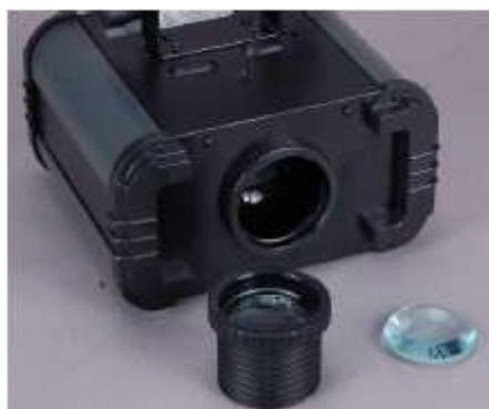
Schrauben Sie die Fokuslinse ab. Drücken Sie mit dem Daumen leicht nach außen, bis sie herausragt.
