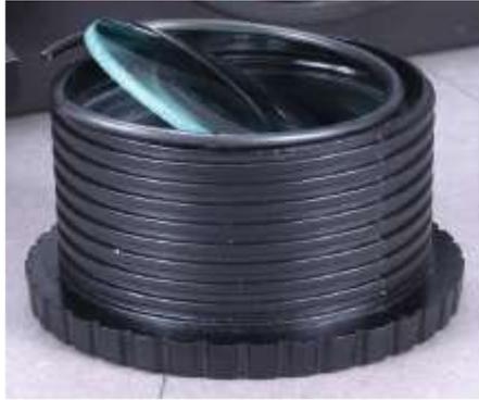
Das Herausragen der Linse sollte wie auf der linken Abbildung dargestellt sein. Entfernen Sie die Linse und den Rückhaltering.
