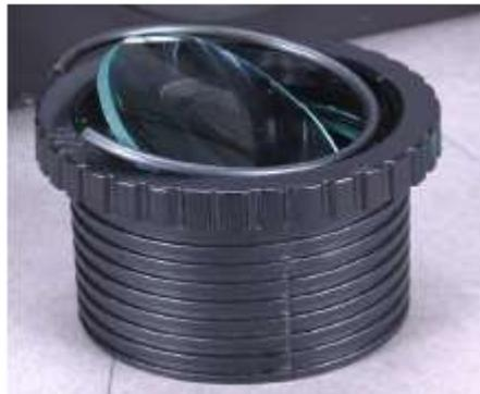
Drehen Sie den Objektivtubus um und fügen Sie die Linse ein. Legen Sie wieder vorsichtig den Rückhaltering ein. Seien Sie bei diesem Vorgang bitte sehr achtsam. Stellen Sie sicher, dass der Rückhaltering korrekt eingepasst ist und drücken Sie ihn passgenau gegen die Linse. Jetzt können Sie die Fokusslinse wieder in Ihren H2O IR einschrauben.
