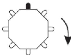
Para la rotación en sentido contrario a las agujas del reloj de una sola barra, ponga los conmutadores 8 y 10 en posición On y el conmutador 9 en posición Off.
