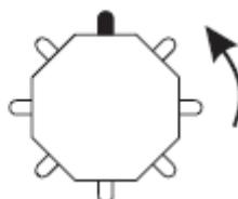
Para la rotación en el sentido de las agujas del reloj de dos barras opuestas, ponga el conmutador 8 en posición On y los conmutadores 9 y 10 en posición Off.
