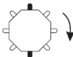
Para la rotación en sentido contrario a las agujas del reloj de dos barras opuestas, ponga los conmutadores 9 y 10 en posición On y el conmutador 8 en posición Off.
