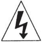
Das Symbol eines Blitzes in einem Dreieck soll den Benutzer vor der Gegenwart nicht isolierter „gefährlicher Stromspannung“ innerhalb des Gerätegehäuses warnen, die in ausreichender Größe anliegt, um einen Stromschlag zu verursachen.
